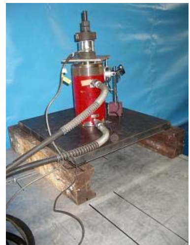
(c) 引抜試験の状況
