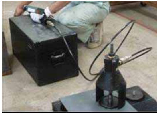
図 - 2 引張試験の状況
