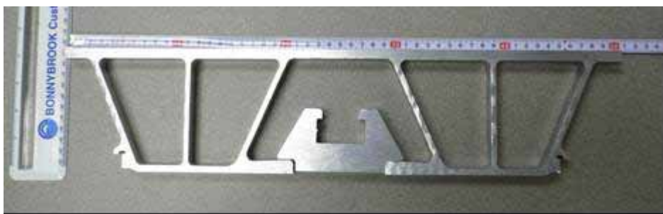
図 - 4 アルミニウム床版の断面
